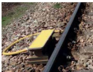
PZB Gleismagnet 2000Hz
